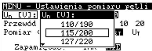
Rys. 9 Wybór napięcia znamionowego sieci
